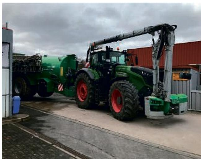
Das Lohnunternehmen Timmerberg setzt auf die Kompetenz und den Rundumservice der Firma Gücking. Bei einem 24-Stunden-Schichtbetrieb in der Saison ist ein verlässlicher Partner unersetzlich, um Traktoren wie dieser Fendt 1050 Vario mit 500 PS und Hinterrädern in 46-Zoll einsatzbereit zu halten.
