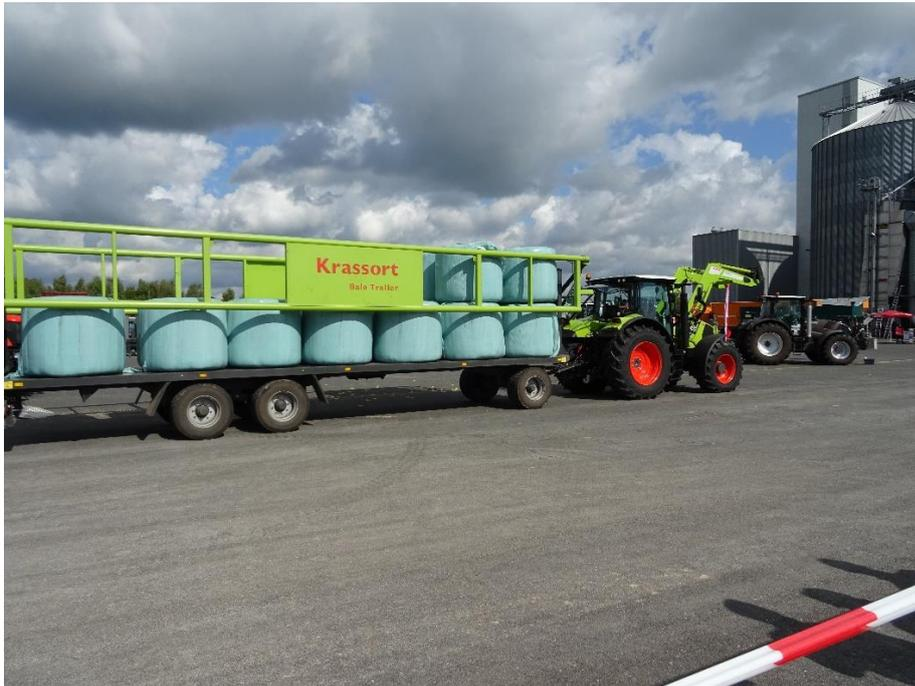
Bild 4: Eine sichere Beförderung von Ballen jeglicher Art, ist mit einem Transportwagen mit hydraulischen Klemmgattern möglich. (Foto: Vaupel)
