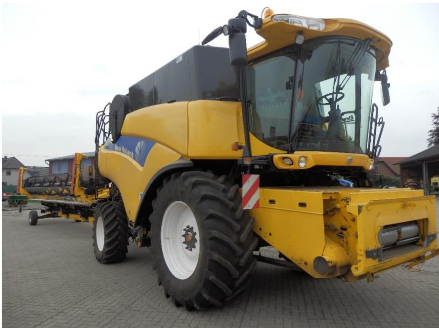
Bild 1: Bei mehr als 3,00 m Breite oder einer Zuglänge die 18,00 m übersteigt, ist für den Mähdrescher eine Ausnahmegenehmigung erforderlich. Die Genehmigung ist während der Fahrt mitzuführen. (Foto: Vaupel)
