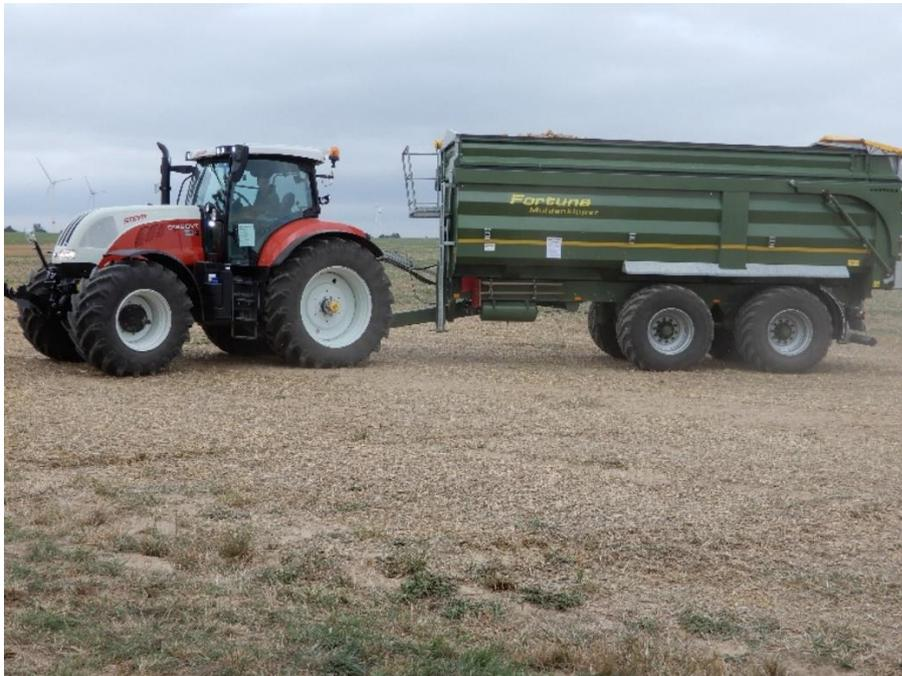
Bild 2: Bei einem Zug mit 4 Achsen darf das Zuggesamtgewicht 36 t betragen. Auf die Einhaltung der Einzelgewichte, Achslasten und Stützlasten ist zu achten. (Foto: Vaupel)
