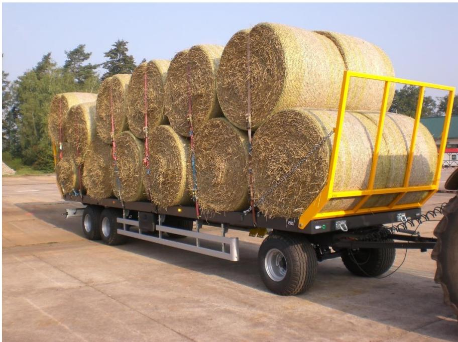
Bild 3: Spezieller Ballentransportwagen mit Ladegatter und guten Zurrpunkten. Allerdings kann auf Zurrgurte auch bei diesem Transport nicht verzichtet werden. (Foto: Vaupel)
